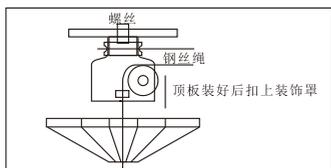
飞碟型顶座安装方法
