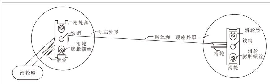
图C-2 滑轮座与顶座呈90°情况下安装方法
